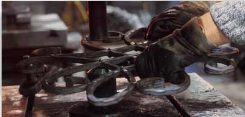
Esecuzione battitura rivetti (art. 4265) Rivets hammering (art. 4265)
